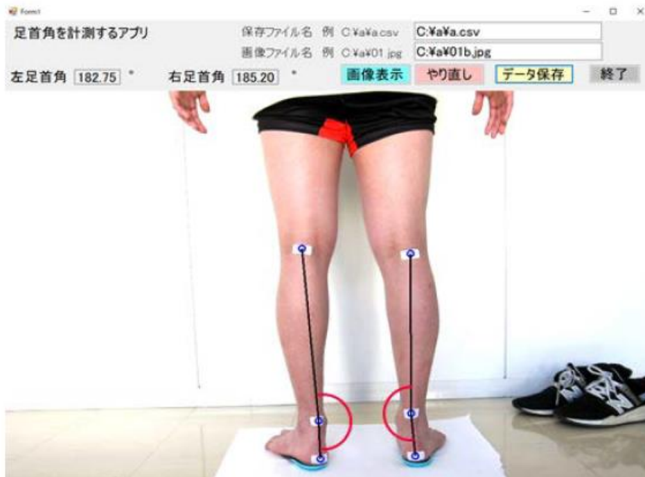
図4 ビデオ式モーションキャプチャーによる足首角計測アプリ
