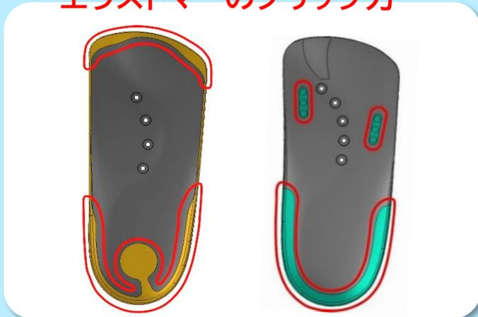
赤線で囲った部分にエラストマーを装着しています。エラストマーはゴムのようなグリップ力を持ち、滑りを抑えることができるため、足とインソールのフィット感を高めます。また、インソール自体が靴の中で動くことも防ぐため、足が安定しスポーツシーンでも使用することができます。
